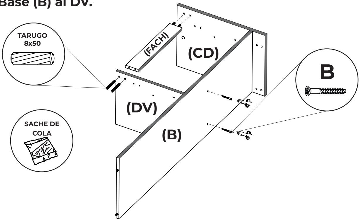
**4** Colocar cola y los tarugos (2) en los orificios inferiores de los laterales de los zócalos. Colocar los tornillos armadores (2) para unir el CD con los zócalos.
