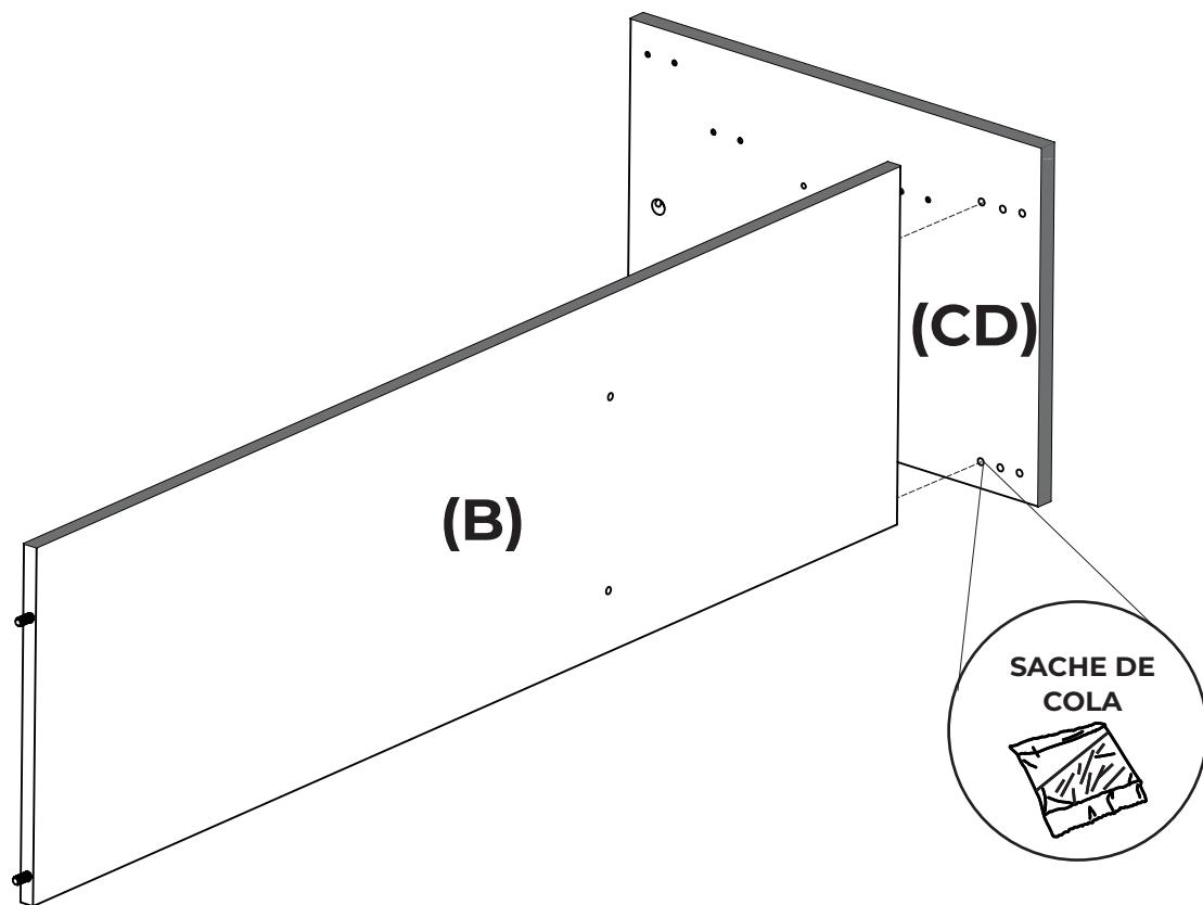
**3** Colocar cola en los orificios del CD que se indican en la imagen. Colocar los tarugos en los laterales de la Faja chica (FACH). Unir la faja chica con el CD y DV. Por ultimo colocar los tornillos armadores (2) para fijar la Base (B) al DV.
