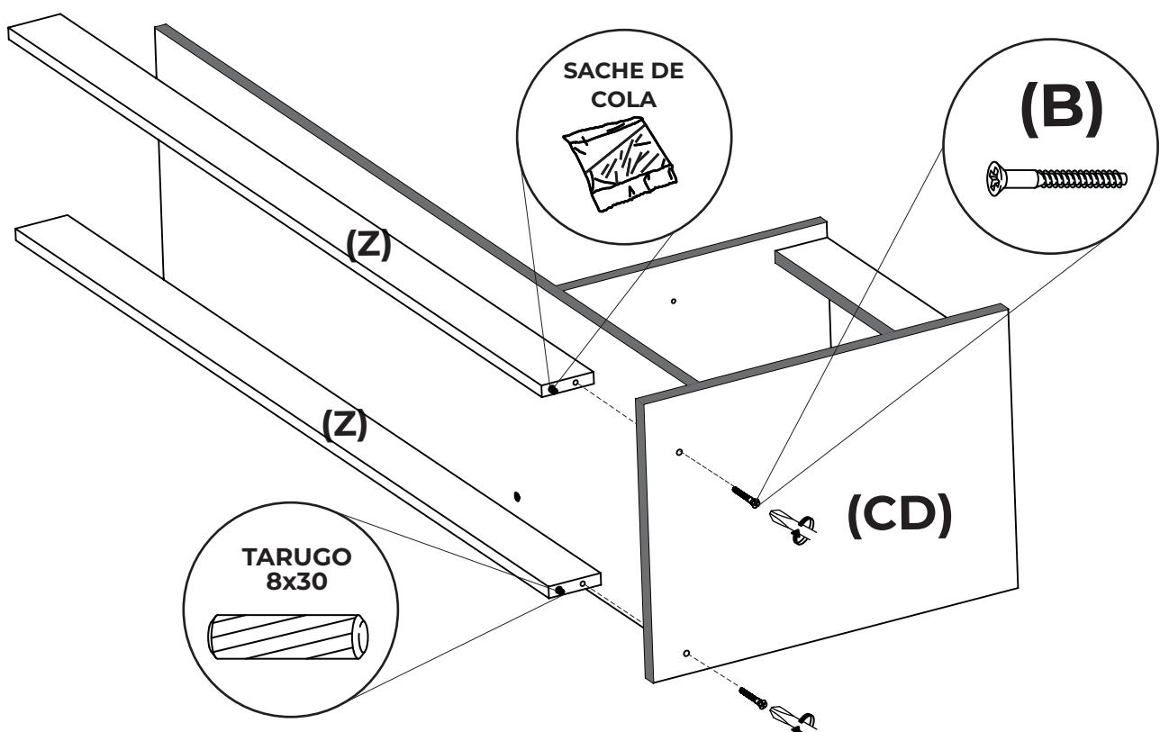
**5** Colocar cola y tarugos (2) en los orificios laterales de la Faja grande (FAG) . Unir las piezas como indica la imagen haciendo coincidir los orificios del CI con los tarugos de las piezas B, Z, Y FAG. Por ultimo colocar los tornillos armadores (2).
