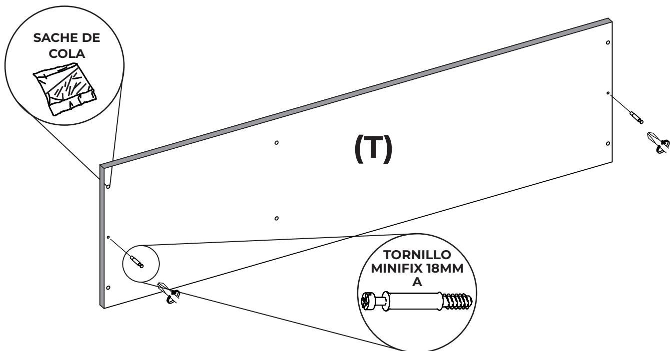
**7** Encolar los agujeros y colocar los tarugos (4) en los filos de las piezas CI, CD y DV. Luego ensamblar la tapa a los costados (CI) (CD) y a los divisores (DV). Por último colocar la cazoleta minifix de 18mm en los (CI) y (CD) y girar con un destornillador para ajustar.
