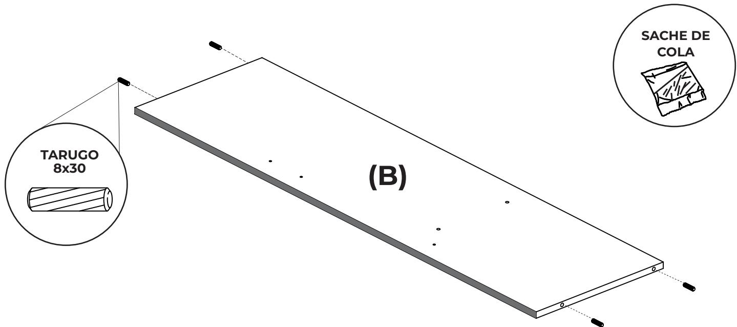
**2** Colocar cola en los agujeros del costado derecho (CD) como se indica en la imagen. Hacer coincidir los orificios encolados con los tarugos de la base.
