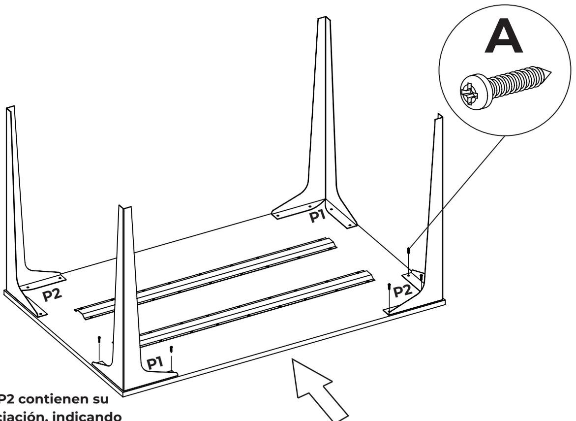
**Nota:** las patas P1 y P2 contienen su etiqueta de diferenciación, indicando pata 1 y pata 2 respectivamente.
