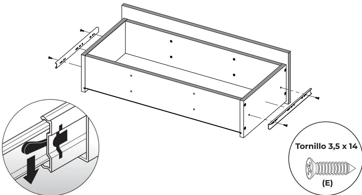
**19** Alinear los orificios de las guías de corredera con las marcas en el DVV Y CD y luego atornillar con tornillos 3,5 x 14. Luego posicionar el cajon previamente ensamblado.
