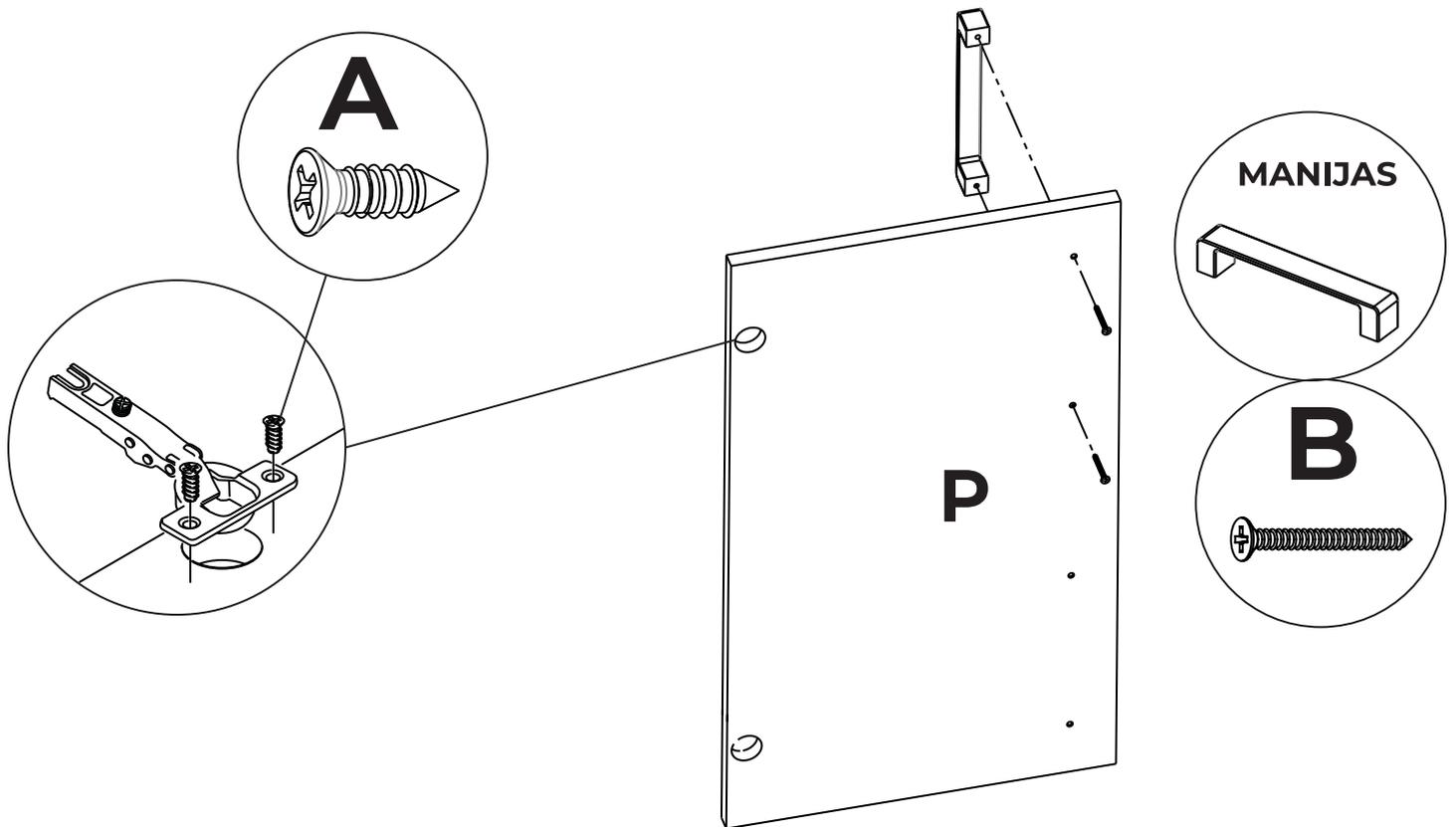
**4** Colocar la otra parte de la bisagra en el ensamblaje y unir ambas partes colocando la puerta como se muestra a continuacion. Luego colocar los corredores de las bandejas.
