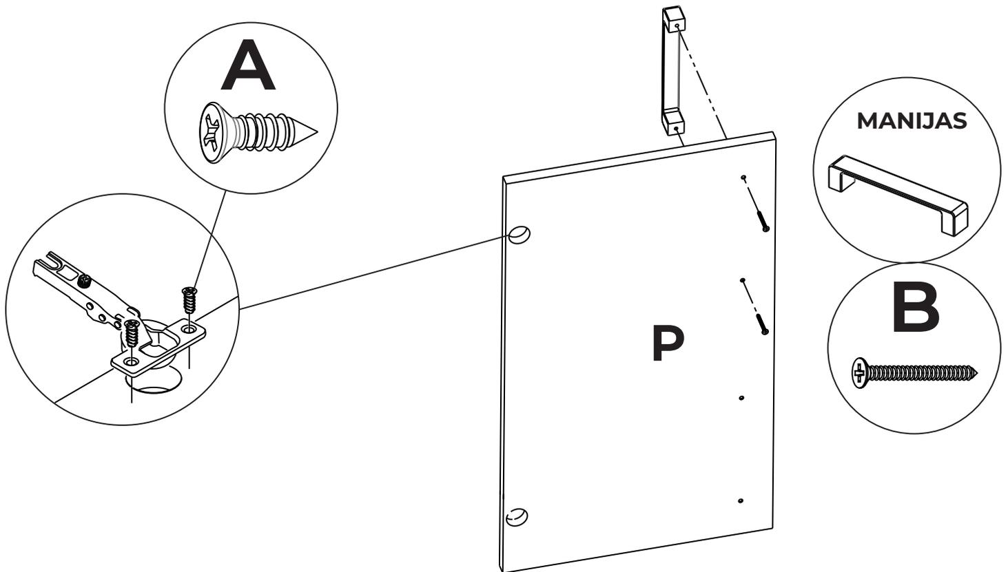
**4** Colocar la otra parte de la bisagra en el ensamblaje y unir ambas partes colocando la puerta como se muestra a continuación. Luego colocar los corredores de las bandejas y del cajón.
