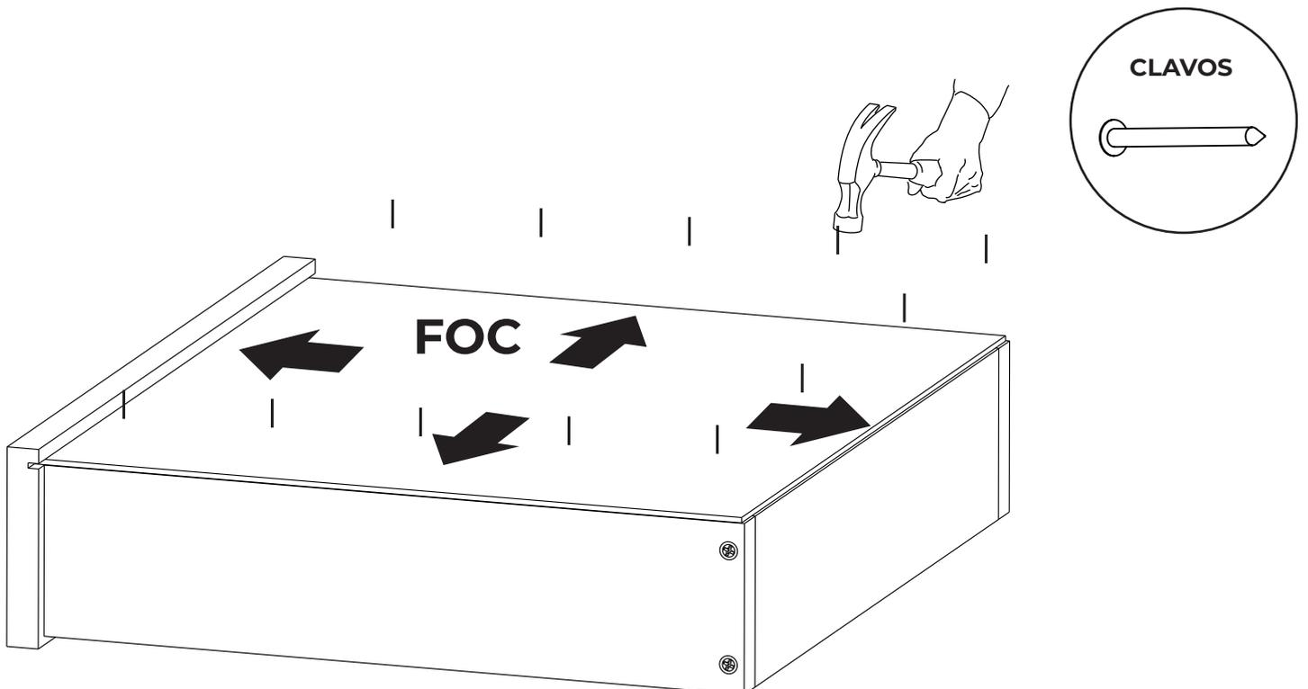
**7** Colocar las guías en el cajon apoyando sobre los costados de cajon (CC) el fondo de cajon (FOC) y el frente de cajon (FC). Luego ajustar con un tornillo en cada extremo como se muestra a continuación. Luego colocar el cajon en el ensamblaje.
