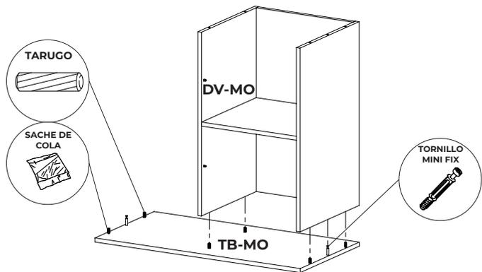
**6** Cerrar el ensamblaje mediante el costado izquierdo (CI-MO) y la tapa base (TB-MO) superior utilizando el herraje indicado a continuación. Previamente haber encolado los agujeros que alojan los tarugos. Luego colocar los soportes de estantes y el estante apoyado sobre estos.
