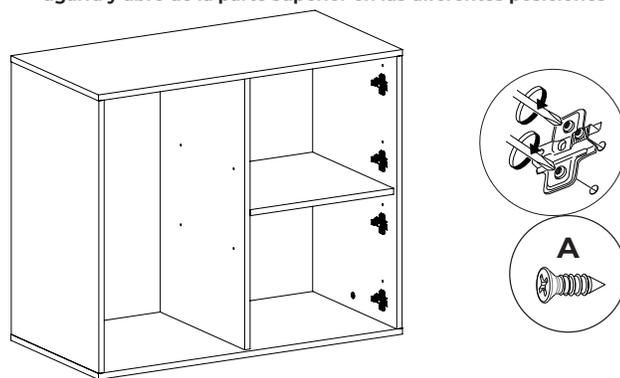
**8** Colocar las bisagras en las puertas para luego unir las puertas al ensamblaje vinculando las dos partes de las bisagras como se muestra a continuación.
