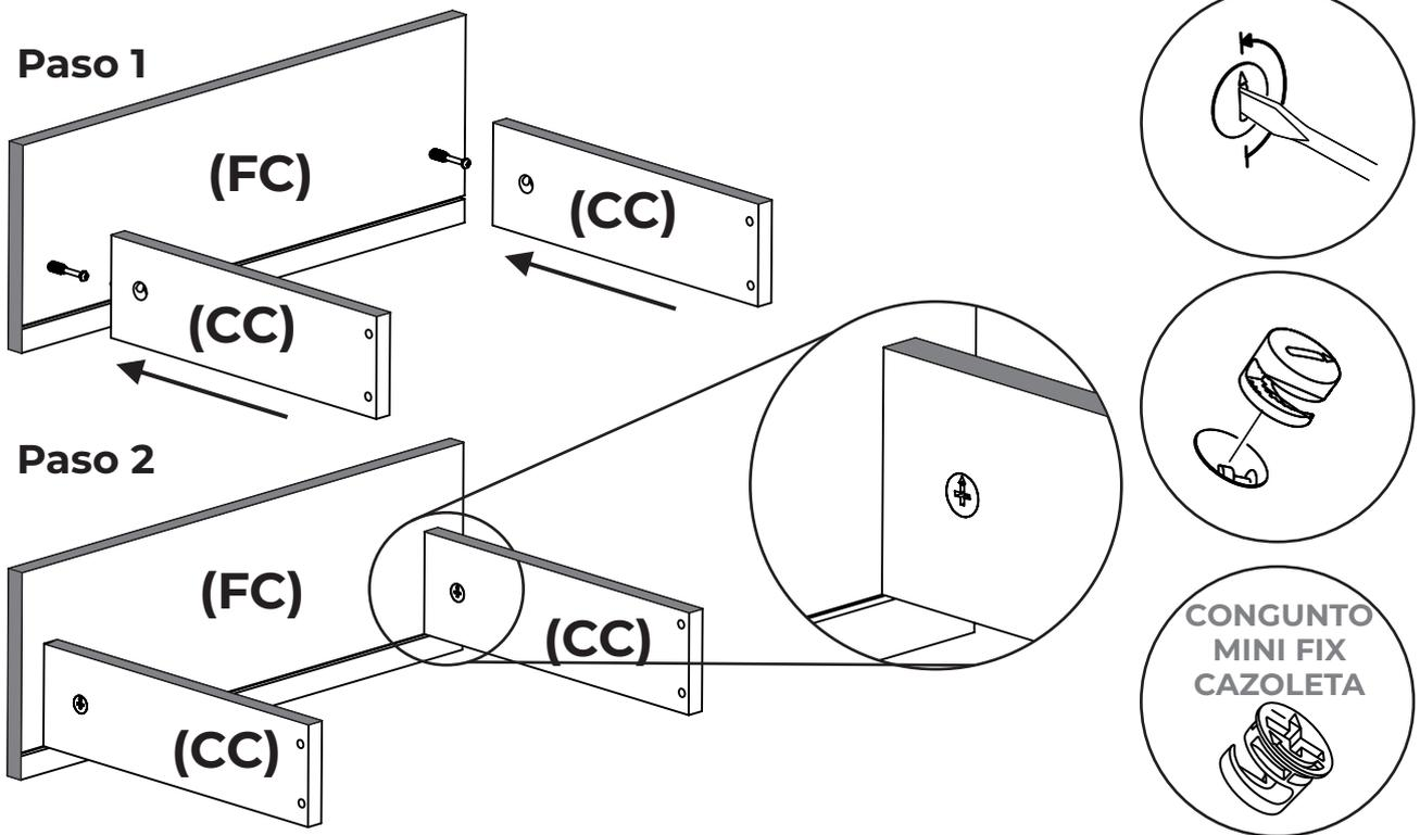
**6** Como primer paso del armado del cajón se colocan los tornillos del conjunto mini fix en los agujereados del frente cajón (FC)
