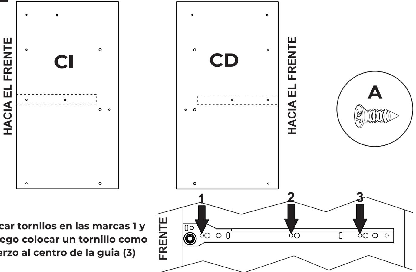
Colocar tornillos en las marcas 1 y 2. Luego colocar un tornillo como refuerzo al centro de la guia (3)
