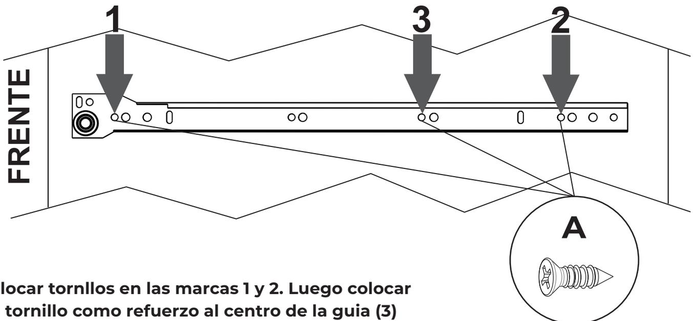
Colocar tornillos en las marcas 1 y 2. Luego colocar un tornillo como refuerzo al centro de la guia (3)
