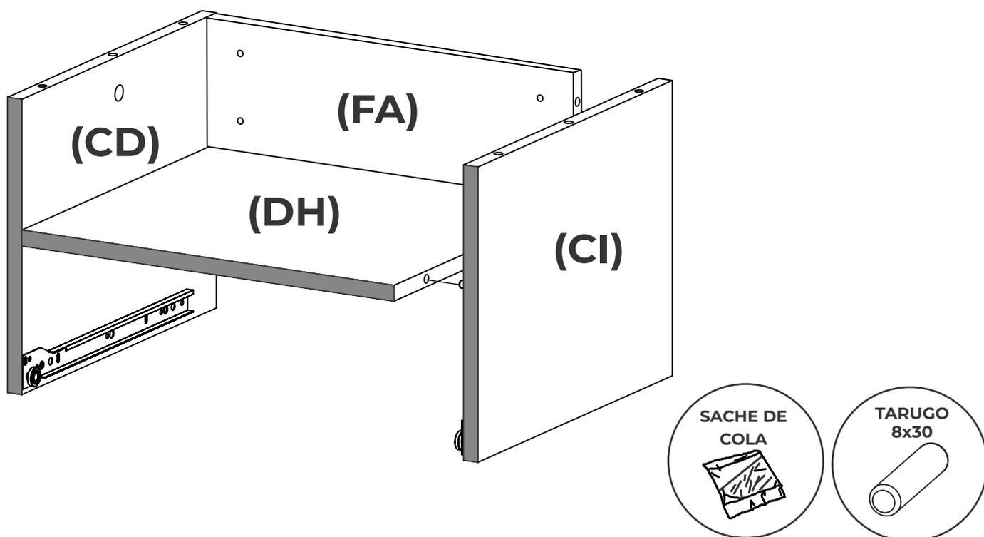
**5** Colocar los tarugos en la parte inferior de ambos costados (CD) y (CI) con cola vinilica, y luego unir la base atornillandola.
