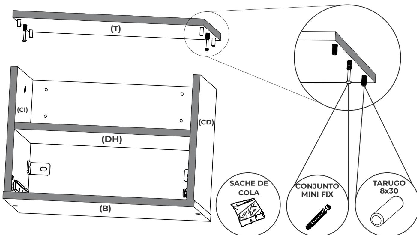
**7** Ya colocada la tapa (T) con los tarugos y el tornillo del conjunto mini fix colocar y ajustar la cazoleta como lo indica la imagen
