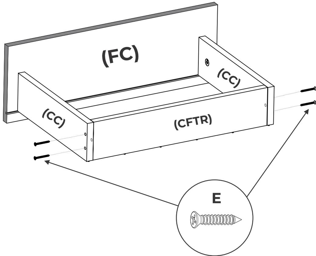
**12** Colocar el fondo cajón (FOC) por debajo del cajon previamente ensamblado, al colocarlo encastrar el fondo con el frente de cajón (FC) en la ranura que tiene el mismo, luego colocar los clavos como se muestra a continuación.
