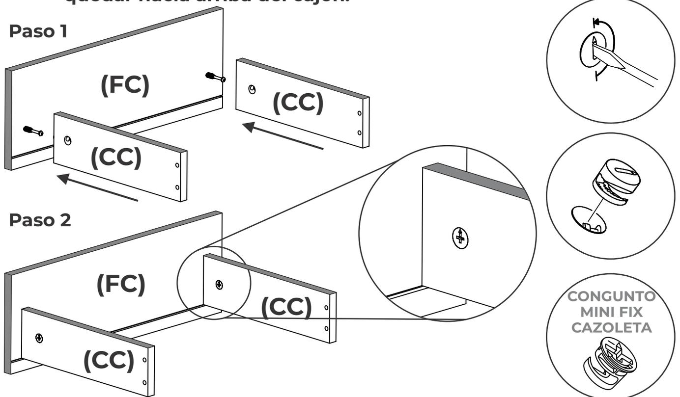
**11** Como primer paso del armado del cajón se colocan los tornillos del conjunto E en los agujereados del contrafrente trasero de cajón (CFTR)
